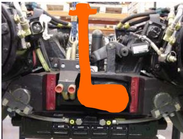
Fig. 24 Braço e ligação vertical da barra anti-rolamento
