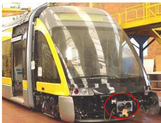
Fig. 69 engate automático no veículo Metro do Porto
