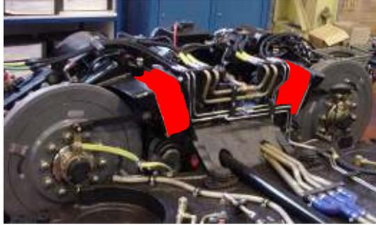
Fig. 14 Fotografia do bogie onde se podem visualizar as molas de borracha da suspensão primária (a encarnado)
