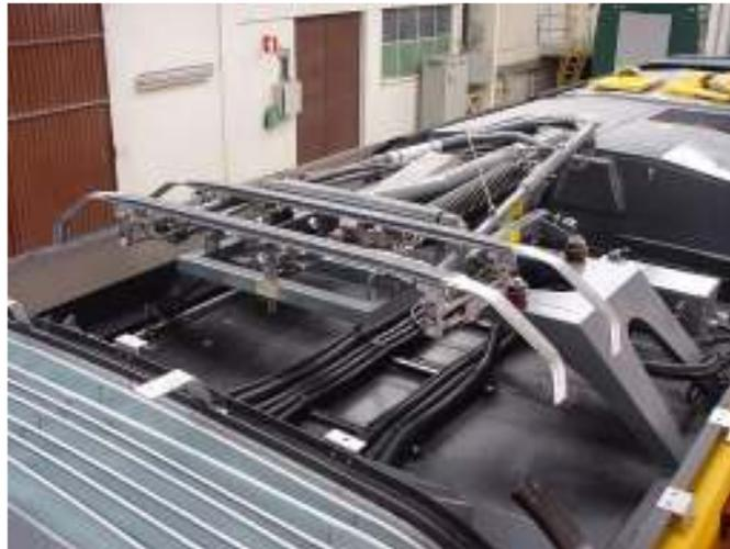
Fig. 51 Pantógrafo de braço articulado simples (recolhido)
