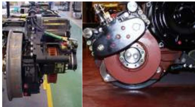
Fig. 46 Frenagem electro-hidráulica
