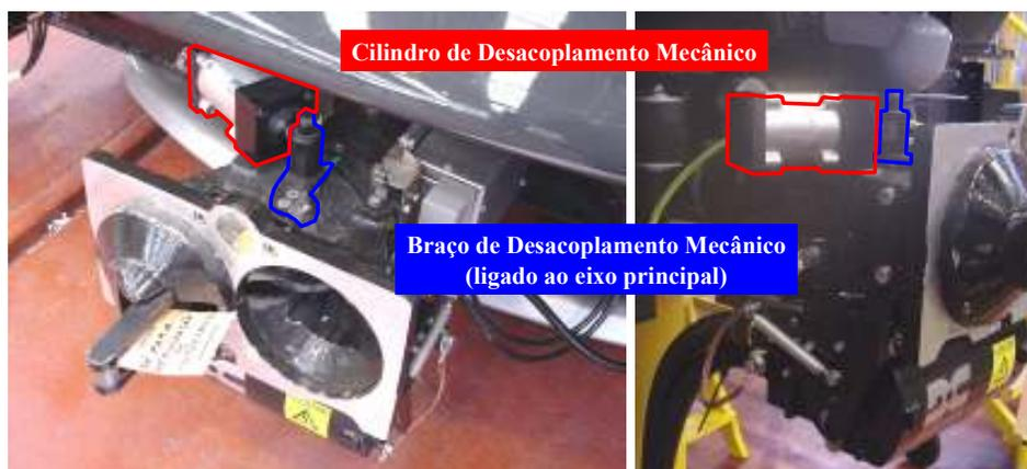
Fig. 79 Intervenientes na operação de desacoplamento mecânico automática
