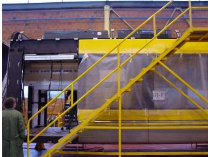
Fig. 30 Lateral do veículo em fase de construção (salão de passageiros, módulo F)
