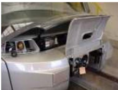
Fig. 71 Abertura da porta retráctil para extracção do engate
