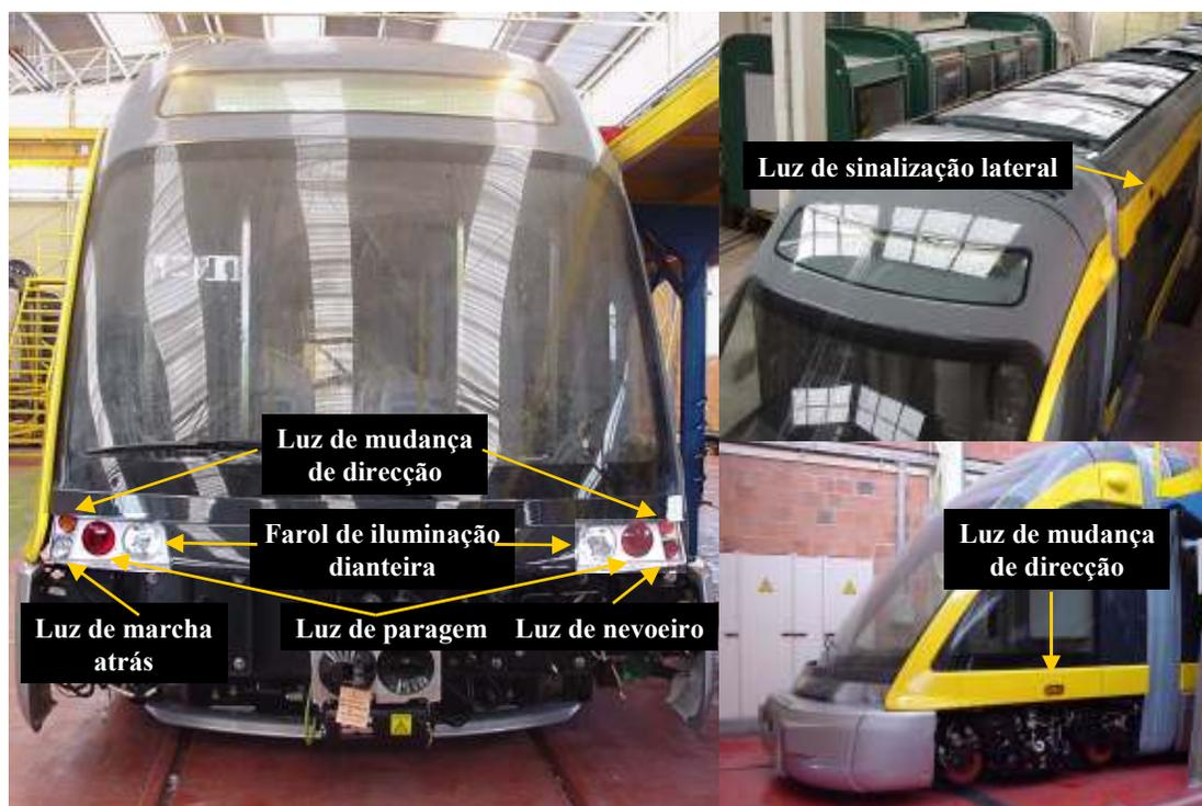
Fig. 59 Sistema de iluminação exterior do veículo metro do porto
