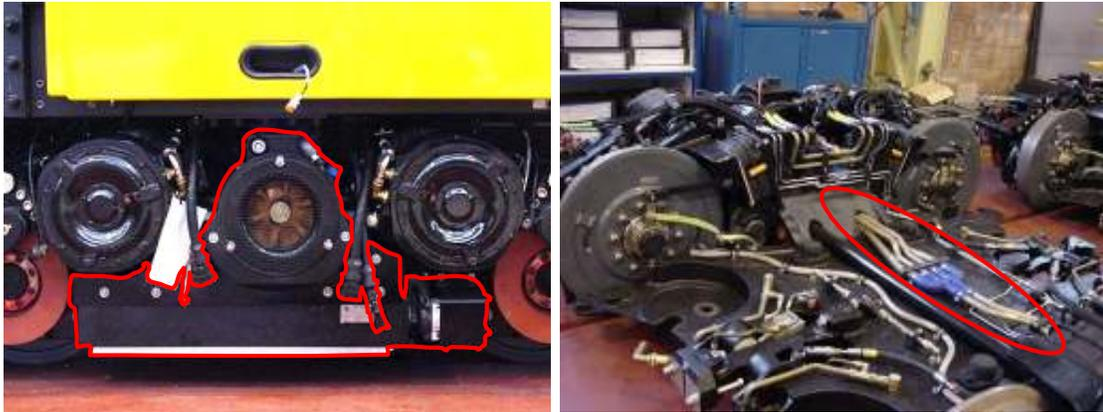
Fig. 42 Grupo de refrigeração dos motores de tracção e tubagens de distribuição do fluido refrigerante
